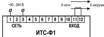
Рисунок 5.3 – Схема подключения с трансформатором
