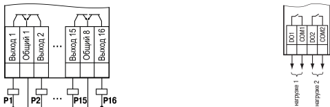
Рисунок 10 – Схема подключения ВЭ типа «Р»
