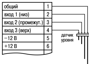
Рисунок 5.3 – Схема подключения кондуктометрических датчиков уровня
