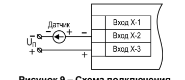
Рисунок 9 – Схема подключения пассивного датчика с токовым выходом 0...5 мА или 0(4)...20 мА
